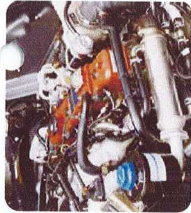
Motor Diesel con nivel de emisiones EURO IV, Turbo cargado e intercooler para mayor aprovechamiento de la potencia
